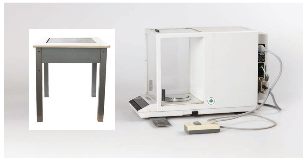
Veiebord og analysevekt fra Ullevål apotek. Veiebordet var plassert i magistrell reseptur med analysevekten stående oppå. Bordet er av tre med innlagt, frittliggende, tung stenplate som hviler på to tverrliggende metallskiner boltet fast i bordet. Det er konstruert slik for å eliminere rystelser og bevegelser, og gjøre vekten helt stabil – spesielt viktig ved veiing av små mengder stoffer. Bordet og vekten ble gitt til Farmasimuseet i 2016. Foto: Stian Nybru.
