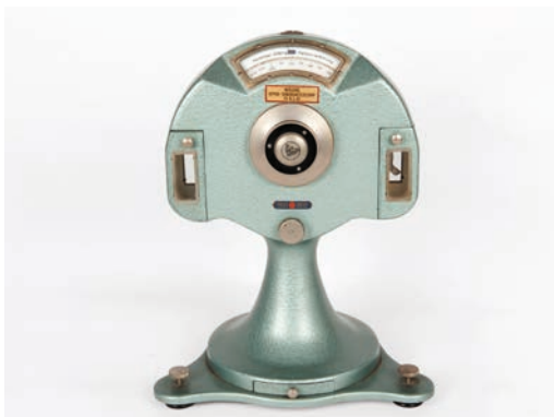
Denne vekten har vært brukt på Rikshospitalets apotek og ble gitt til museet i 1974. Slike kontrollvekter var ofte automatiserte og svært presise, og de inngikk som en del av kvalitetskontrollen på produksjonslinjen. Kontrollvekten veide hver enkelt tablett eller kapsel, og produkter som avvek fra den spesifiserte vekten ble automatisk sortert ut. Foto: Jon-Erik Faksvaag.
