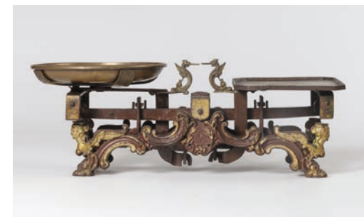
Denne bordvekten i nyrokoko-stil har en fast veieplate i stedet for to skåler. Den har føtter i kvinnehode-form og bronserede detaljer. Indikatorene (tungene) er utformet som vingede drager. Fra dragenes åpne munnner stikker det ut flate metalltunger som møtes når vekten er i balanse. Foto: Stian Nybru.
