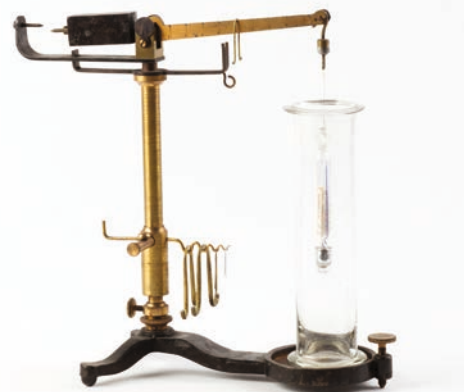
Denne vekten har vært brukt på Løveapoteket i Oslo og ble gitt til museet i 1970. Det hører en oppbevaringskasse av tre med glass i front til vekten. Bruken av Mohr-Westphals vekt bygger på Arkimedes' prinsipp, om at et legeme som senkes i væske påvirkes av en oppdrift tilsvarende den fortrenkte væskens vekt. Foto: Eva Brænd.
