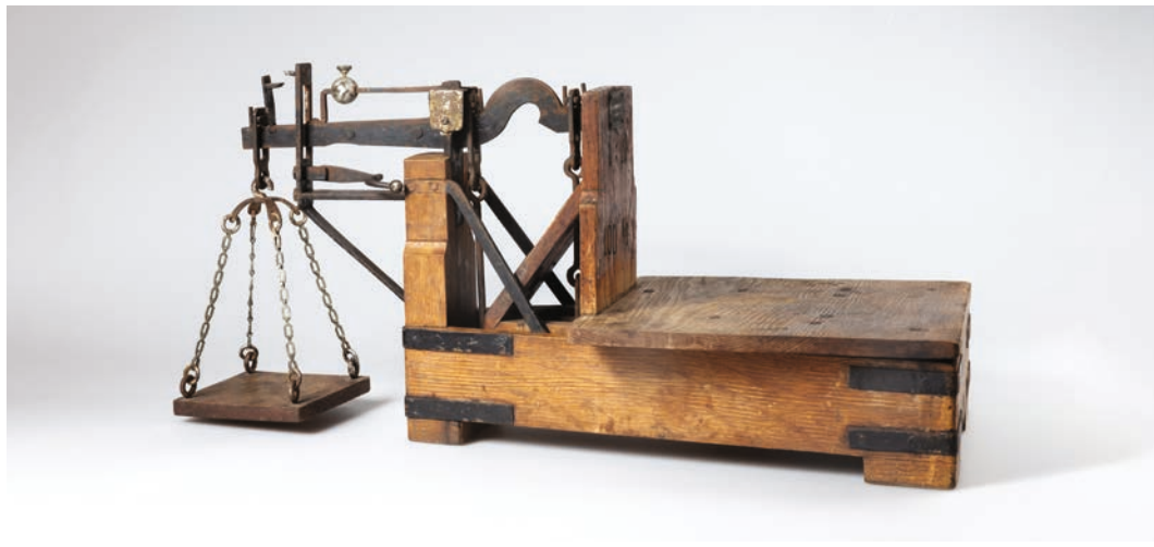
Desimalvekt til laboratoriebruk i eik og jern, produsert av Viig & Wraalsen, Mekanisk Værksted, Christiania (etablert 1879). Vekten har vært brukt på Apoteket Ørnen i Moss og kan ha blitt kjøpt inn da apoteket ble etablert i 1886. Gitt til Farmasimuseet i 1965. Foto: Stian Nybru.
