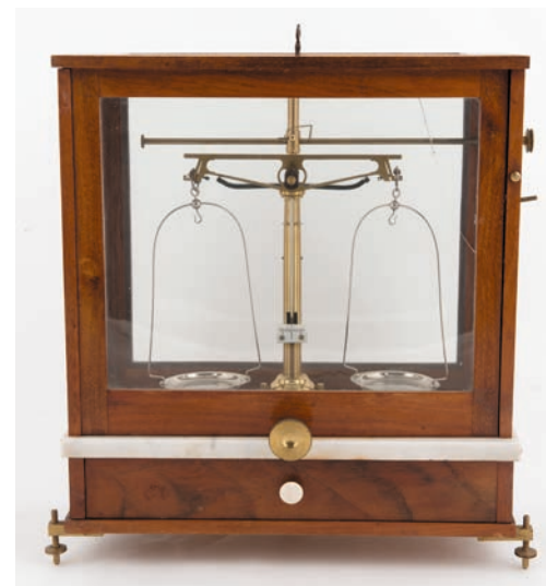
Analysevekt i trekasse. Vekten er montert på en tung og plan marmorplate som demper vibrasjoner og gir stabilitet ved presis veiing. Under platen er det en skuff med utstyr som lodd-sats, pinsett, pensel mm. Viseren – en fin stang montert under midtpunktet på bjelken – peker nedover. Når vekten er i likevekt, står viseren stille i midtstilling. Analysevekten ble brukt til svært nøyaktige veiinger bl.a. ved kvantitativ analyse. Foto: Jon-Erik Faksvaag.
