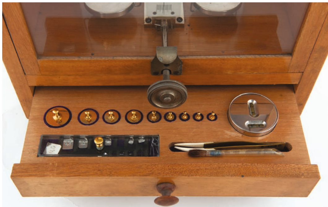
Analysevektene var gjerne utstyrt med en skuff som inneholdt vater, lodd, pinsett og pensel. Vekten måtte stå helt i vater for å sikre nøyaktig veiing. Foto: Jon-Erik Faksvaag.
